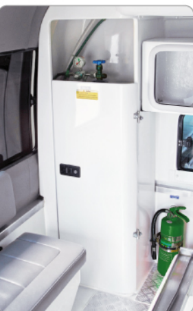
ตู้เก็บถังออกซิเจน พลิตจากไฟเบอร์กลาสชนิดเดียว สามารถเปิด/ปิดได้ เพิ่มความเป็นระเบียบเรียบร้อยง่ายต่อการดูแลรักษา
