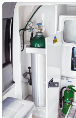
ตู้เก็บถังออกซิเจน พลิตจากไฟเบอร์กลาสชนิดเดียว สามารถเปิด/ปิดได้ เพิ่มความเป็นระเบียบเรียบร้อยง่ายต่อการดูแลรักษา
