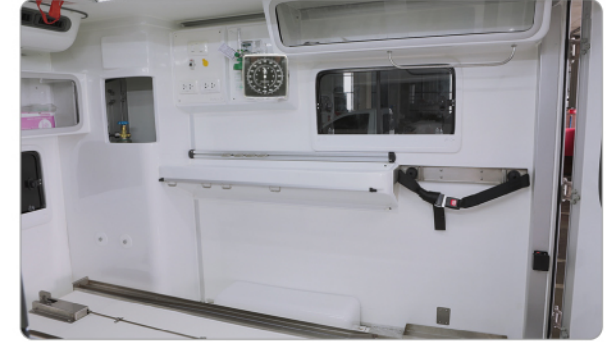
ที่เก็บสัมภาระขนาดใหญ่ 2 จุดพร้อมเคาน์เตอร์วางครุภัณฑ์ทางการแพทย์ เอนกประสงค์ 1 จุด สะดวกในการใช้สอย ผลิตจากไฟเบอร์กลาสชั้นเดียว
