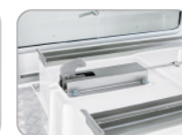
พร้อมระบบชุดล็อกเตียง ผู้ป่วยเป็นแบบอัตโนมัติ ปลดล็อกได้ทั้ง 2 ระบบ ทั้งระบบไฟฟ้าและระบบธรรมดา สามารถเลือกใช้ได้ตามนัดของผู้ใช้งาน
