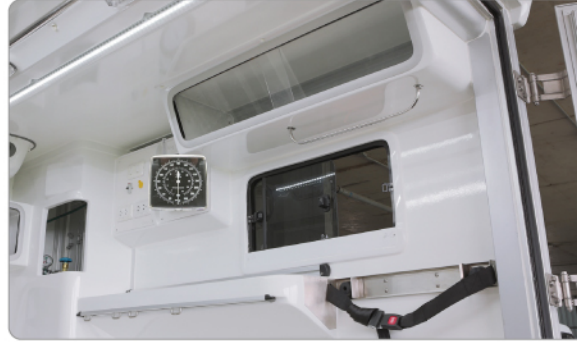
ที่เก็บสัมภาระขนาดใหญ่ 2 จุดพร้อมเคาน์เตอร์วางครุภัณฑ์ทางการแพทย์ เอนกประสงค์ 1 จุด สะดวกในการใช้สอย ผลิตจากไฟเบอร์กลาสชั้นเดียว
