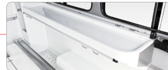
ที่เก็บสัมภาระขนาดใหญ่ 2 จุดพร้อมเคาน์เตอร์วางครุภัณฑ์ ทางการแพทย์ เอนกประสงค์ 1 จุด สะดวกในการใช้สอย พลิตจากไฟเบอร์กลาสชนิดเดียว กันสนิมสวยงาม
