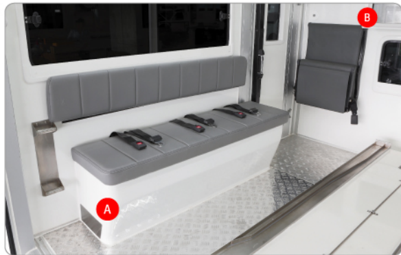
เก้าอี้นั่งยาว 3 ที่นั่ง พร้อมเข็มขัดนิรภัย 3 จุด ด้านข้าง และเก้าอี้พับด้านหน้า 1 ที่นั่ง พร้อมเข็มขัดนิรภัย
